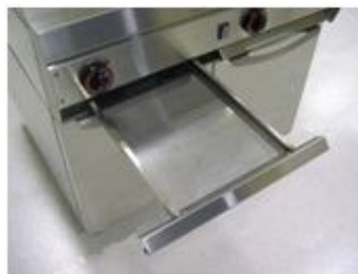
Figura 04 - Retirando a calha coletora de resíduos
