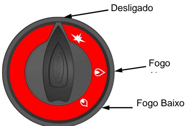
Para ligar o queimador do equipamento, gire o botão correspondente para a posição de fogo baixo e simultaneamente acenda o queimador com um fósforo ou outro dispositivo que produza faísca elétrica. Se desejar, mantenha o botão de comando na posição de fogo baixo. Este procedimento manterá o queimador aceso e com consumo de gás reduzido.
