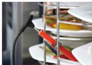
Durante o **Finishing<sup>®</sup>** com a armação móvel para carga múltipla para pratos, coloque o sensor de temperatura de núcleo no tubo de cerâmica do rack móvel para pratos
