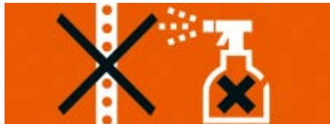
O revestimento da iluminação de LED está bem protegido contra sujeira atrás dos vidros de dentro e central. Apesar disso, é possível que essa área fique suja. Abra os vidros de dentro e central para chegar ao revestimento do LED. Agora é possível limpar os revestimentos. Para isso, limpe fazendo uma leve pressão na superfície das unidades de iluminação utilizando apenas um pano, uma esponja ou papel toalha.
