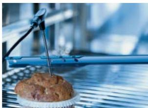
Utilize o auxílio de posicionamento para o caso de o sensor de temperatura de núcleo poder soltar-se sozinho do alimento (por exemplo, alimentos de consistência mole ou pouca espessura).
